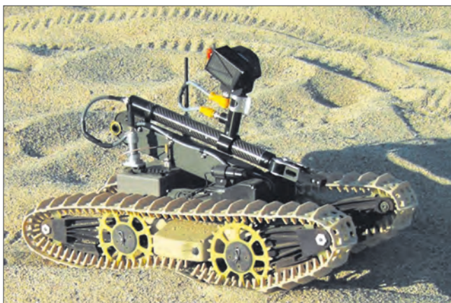
ДУМ «Фёст Лук-110» оснащена четырьмя камерами наблюдения за окружающей обстановкой (на нее можно устанавливать приборы для ведения РХБ-разведки)
