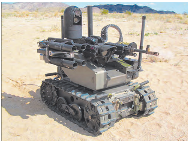
Боевой НРТК «Маарс (спроектирован в Великобритании). Способен нести на борту гранатомет, снайперскую винтовку или пулемет
