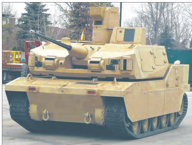
Боевой робот «Блэк Найт» компании «БАэ системз» массой около 9,5 т (основное вооружение – 30-мм автоматическая пушка)
