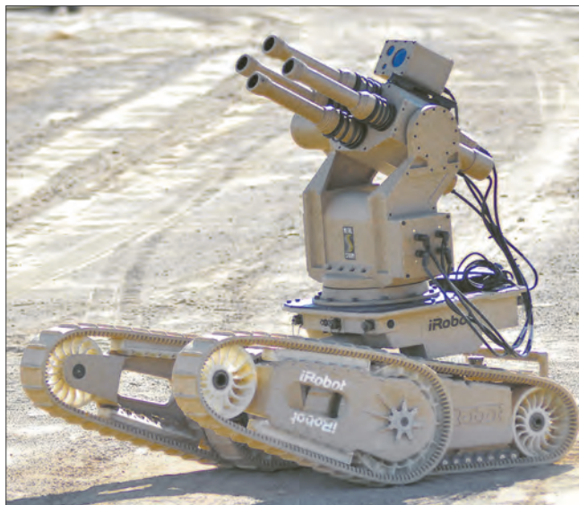
Боевой НРТК «Уорриор» разработан американской компанией «АйРобот» (данный образец оснащен автоматическим четырехствольным 40-мм гранатометом)
