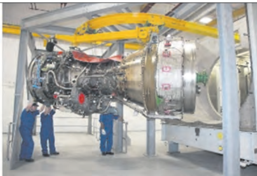
Внешний вид газотурбинного двигателя МТ-30 ФР типа «Глазго»: 1 – воздухозаборник; 2 – теплозвукоизоляционный кожух; 3 – газовая турбина; 4 – выпускной коллектор; 5 – фундаментная рама; 6 – выходной вал
